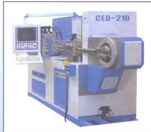
Dobladoras automáticas CNC 3D tridimensionales de 3, 4 y 5 ejes hasta 16 mm. diámetro.
