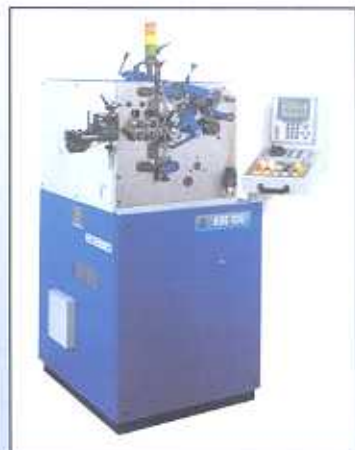
Máquinas para fabricar muelles y resortes con CNC hilo desde 0,2 a 14 mm. de diámetro.
