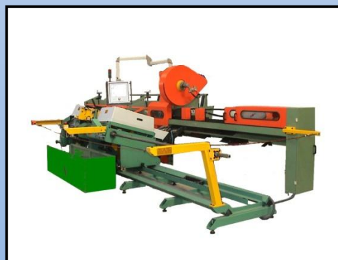
Línea Automática de Corte de Alta producción con desbarbado
